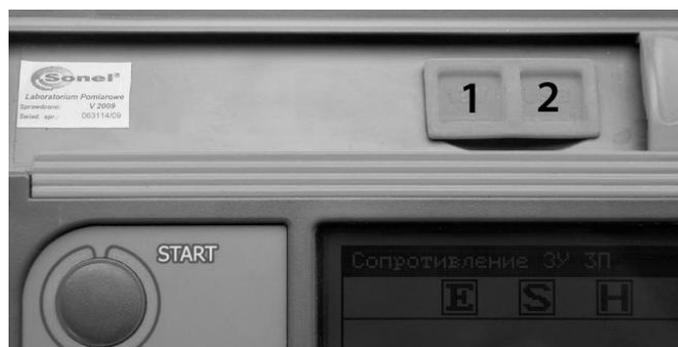
Расположение разъемов зарядки (1) и подключения компьютера USB (2)
