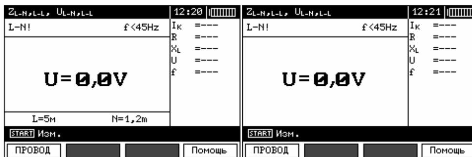
Настройка позволяет включить или выключить строку с параметрами, отображаемую на дисплее. Используя клавиши ▲ и ▼, установите необходимый вариант и нажмите ENTER.
